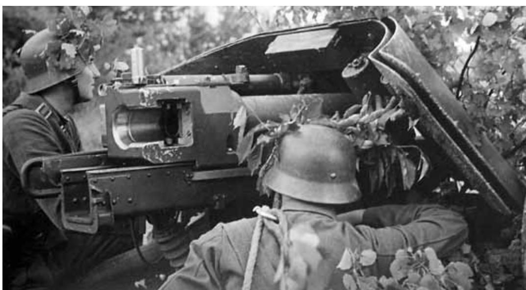
Detailní záběr na závěr protitankového děla Pak 40 z předchozího snímku.
