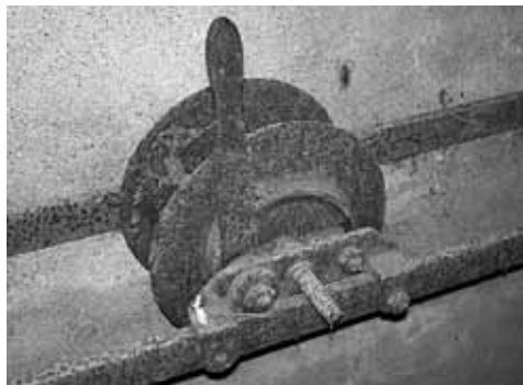
Ruční lanový naviják tzv. typu II.
